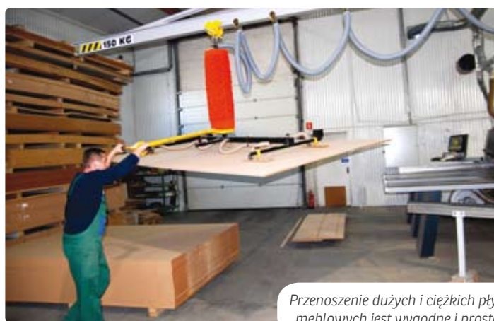
Manipulator MNP 150 posiada wzmocnioną tubę podnoszącą, złącze górne obrotowe, wydłużoną rączkę sterującą, elektryczną pompę podciśnieniową z filtrem i przewodem powietrza oraz przysawkę czterostopową do płyt, z regulowanym rozstawem ssawek.
