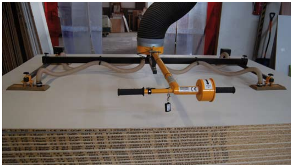
4-ssawkowy chwytak zapewnia stabilny transport elementów w poziomie.
