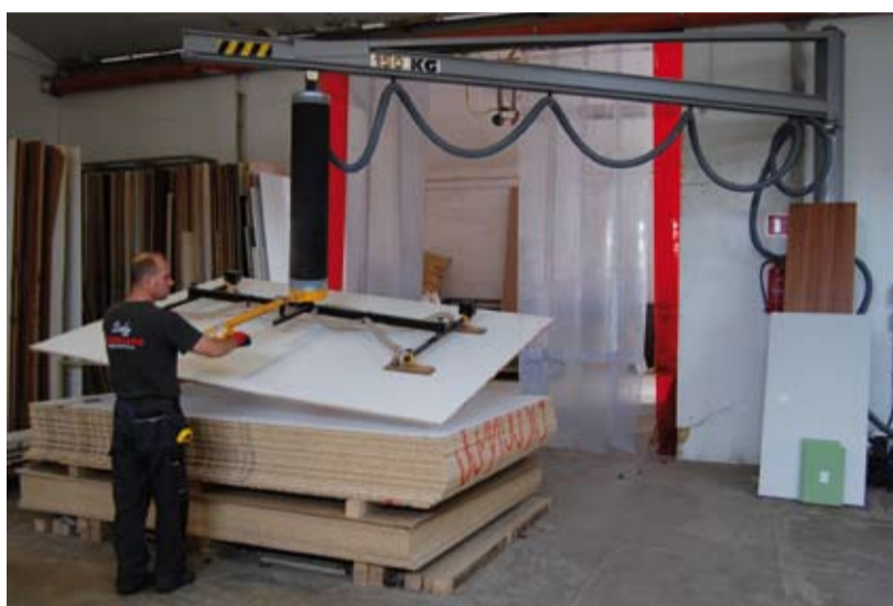
Urządzenie ID Lifting przenosi płyty na stół podawczy pilarki, a operator jedynie nadzoruje ten proces.
