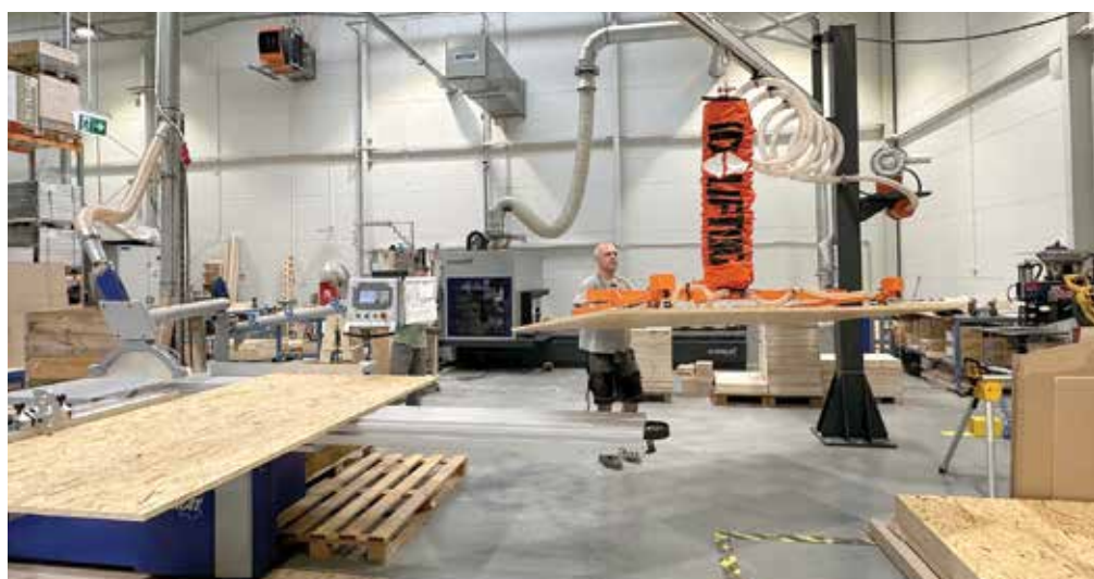
Cztermetrowy wysięgnik manipulatora umożliwia obsługę dwóch gniazd produkcyjnych (załadunek i rozładunek elementów łóżek na centrum obróbcze CNC oraz pilarkę formatową firmy FORMAT4).
