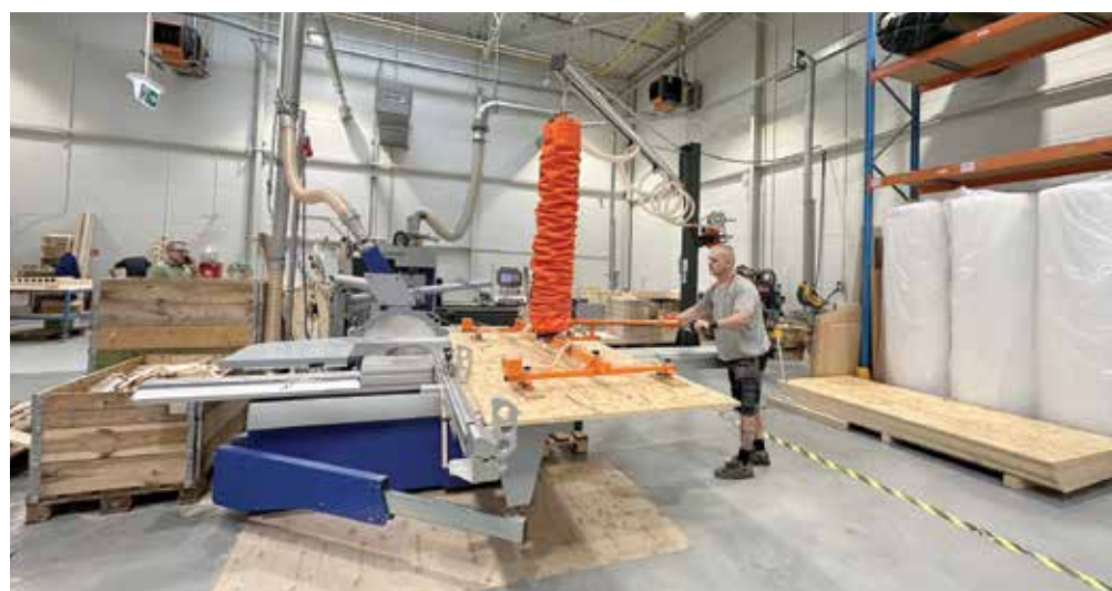
Cztermetrowy wysięgnik manipulatora umożliwia obsługę dwóch gniazd produkcyjnych (załadunek i rozładunek elementów łóżek na centrum obróbcze CNC oraz pilarkę formatową firmy FORMAT4).
